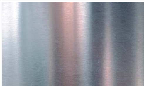
Металл: очищенная щеткой сталь
