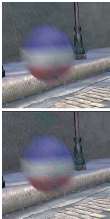
Рис. 5.32. Верхнее изображение приведено в исходном несжатом формате, тогда как нижнее изображение сильно сжато кодеком в формате JPEG. Следует, однако, заметить, что, используя этот формат, можно добиться и намного лучших результатов. А здесь лишь показано влияние сжатия на качество изображения при последовательном его сохранении в формате JPEG
